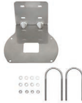
Anten Montaj Kiti (L şeklinde taban plakası, 2 U klempler, 4 M6 somun ve rondela)
